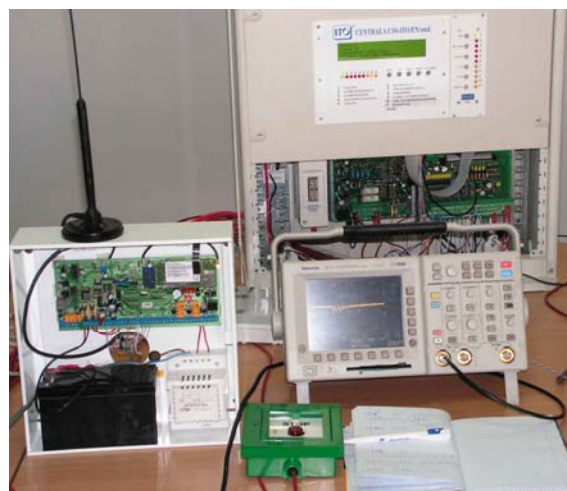
Rys. 1. Badany system przeciwpożarowy
