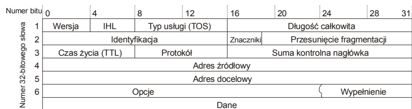
Rys. 1. Struktura pakietu protokołu IP
